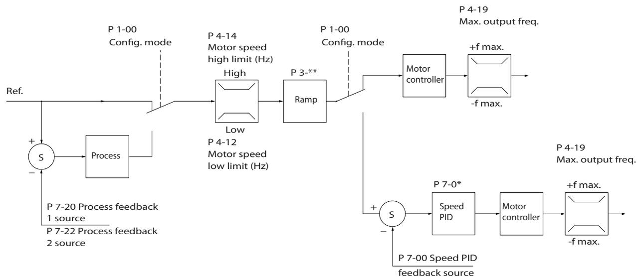
Рисунок 2.12 Структура управления в VVC<sup>plus</sup> — конфигурации с разомкнутым и замкнутым контуром
