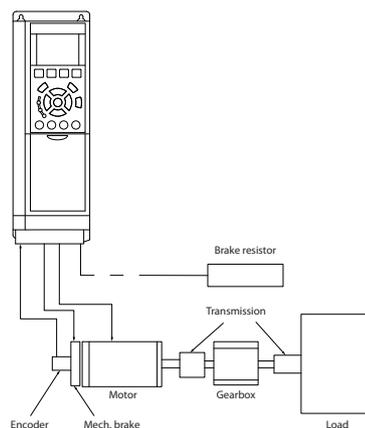
Рисунок 6.4 Базовая настройка замкнутого контура управления скоростью
