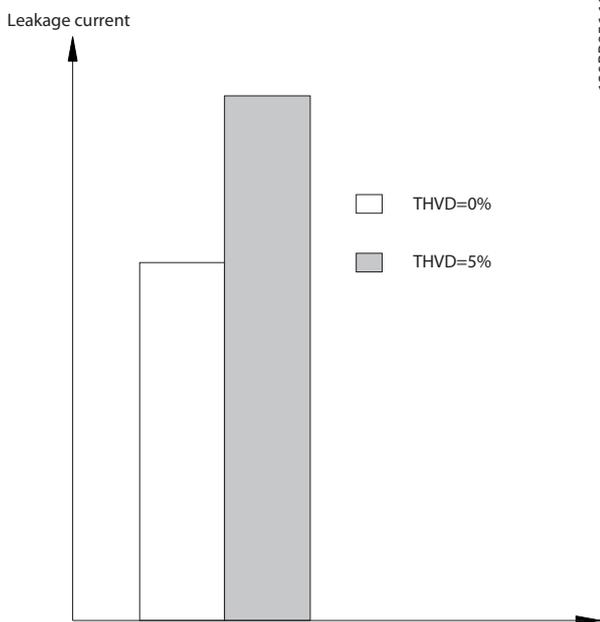
Рисунок 2.30 Зависимость тока утечки от линейных искажений
