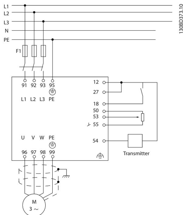
**Рисунок 2.25** Двухпроводный датчик
