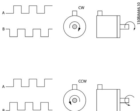
Рисунок 6.3 Инкрементальный энкодер 24 В. Макс. длина кабеля — 5 м.
