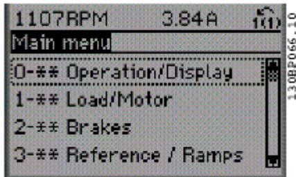
Затем с помощью клавиши [OK] войдите в группы параметров уровня 1-xx. С помощью клавиш ▲ или ▼ выделите 1-6\* *Load Depend. Setting* (Установка, связанная с нагрузкой) и нажмите [OK] для выбора этой позиции. Используя клавиши ▲ или ▼, выберите параметр 1-60.
